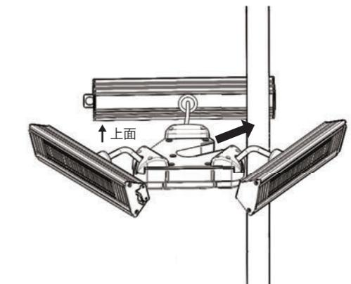
③ ①で外したポール取付固定部をはめ込みます。ポール取付固定ネジおよび補助固定ネジをしっかりとしめ、固定します。
