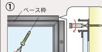
壁面に、ベース枠付きのボードをビスにて取付けます。
