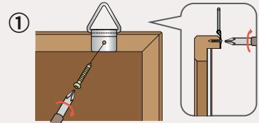
板面裏枠に三角吊金具をビス止めします。
