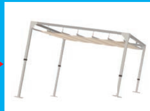
③ 柱を片側ずつ伸ばす
