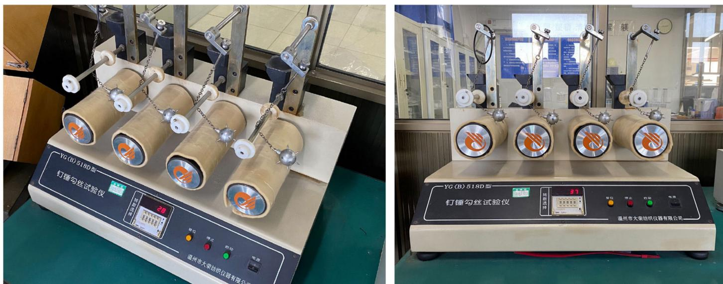
シリンダーに生地を取り付け、表面にゴルフボール大ぐらいの針がいた球体をランダムに飛び跳ねさせ、シリンダーを100回転後に糸の飛び出し等が発生するかを確認します。JISの基準に従って1級～5級で判定をします。
