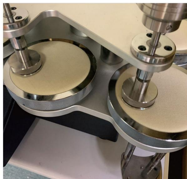
椅子の表面材では、座る部分との摩擦に張材が耐えられるか、基本物性上で最初にクリアーしなくてはならない条件です。弊社では、粗くて強い帆布で何度も擦りつける、学振摩擦機を筆頭に、やすりを使用したテーバー摩擦にて、過去の使用実例と合わせた蓄積された知恵で判断しています。今回は、第3の摩擦試験として、マーチンデール摩擦試験機を導入しました。除菌剤などの薬品を付けた場合や、紫外線劣化させた後の摩擦の場合など、シミュレーションを増やしており、特に、増加している海外のダメレザーの分析に使用しています。
