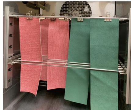
試験片は、恒温器で24時間、一定の温度と湿度の環境に置かれ、公定水分率に近い状態で各種試験が行われます。殆どの物質は、温度と湿度の影響を受ける為です。
