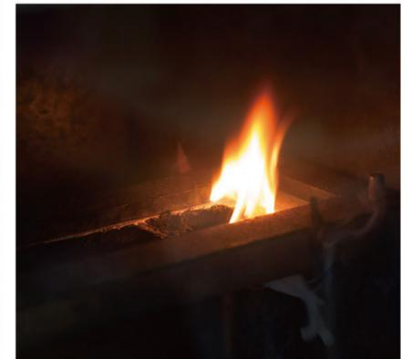
燃え広がるスピードと燃焼跡の長さを測ります。燃え広がる速度が少しでも遅くなることで、人命の安全を確保するのです。
