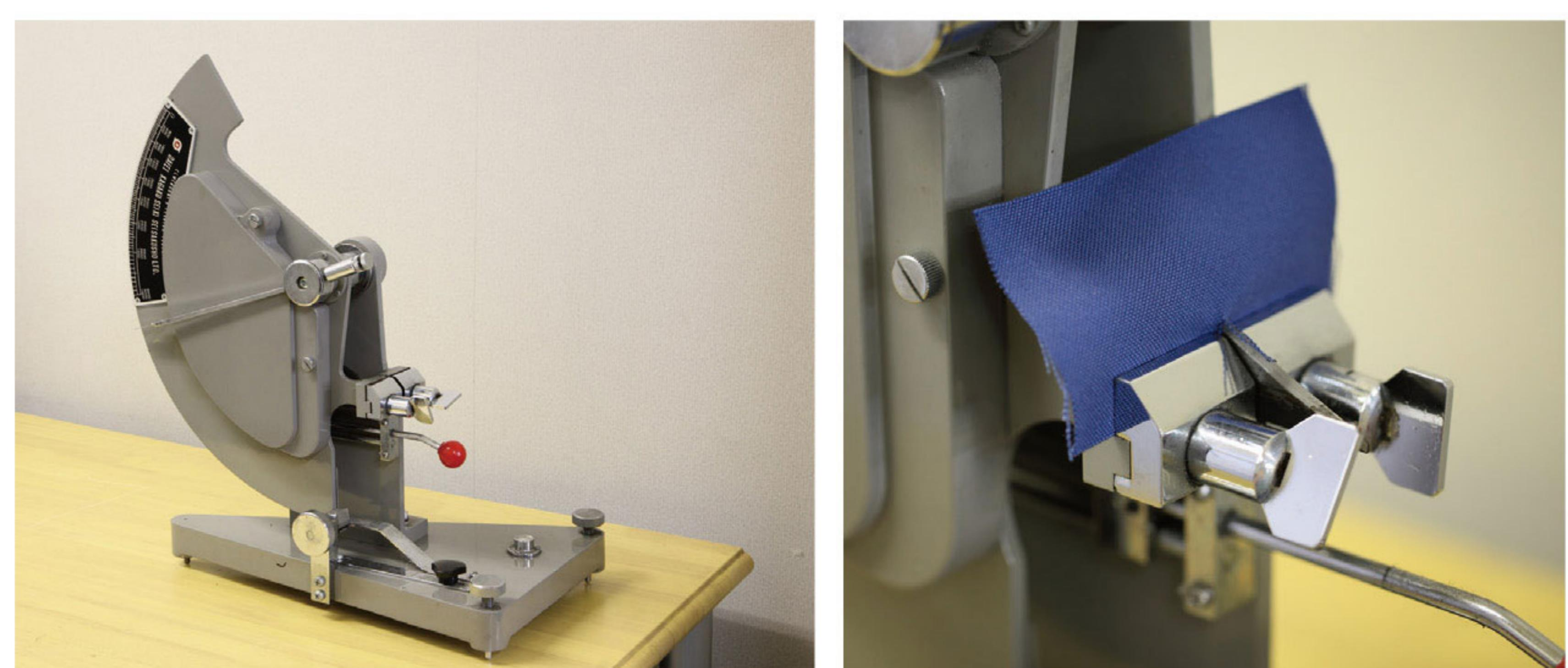
試験片に切り込みを入れ、重量と加速度をかけて引裂きます。引裂くために必要な力を記録します。薄い物は弱い傾向にありますが、糸の太さや糸の本数を変更することで、少しでも強度が上がるよう工夫しています。
