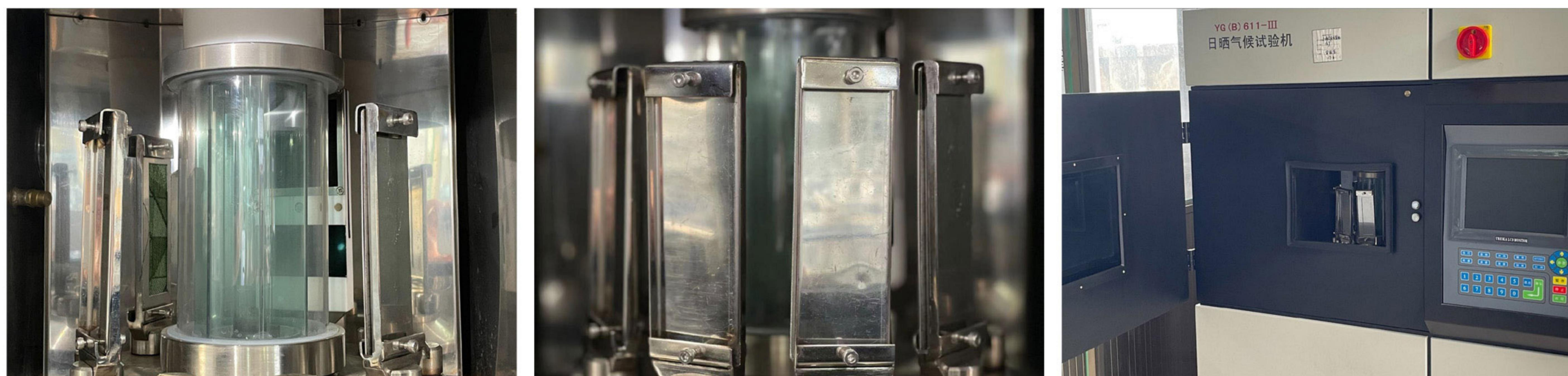
光源が太陽光の光に近いキセノンランプを光らせ、光による色落ち具合を計測します。カーボン光灯とキセノン光灯の両方試験を行う場合もあります。
