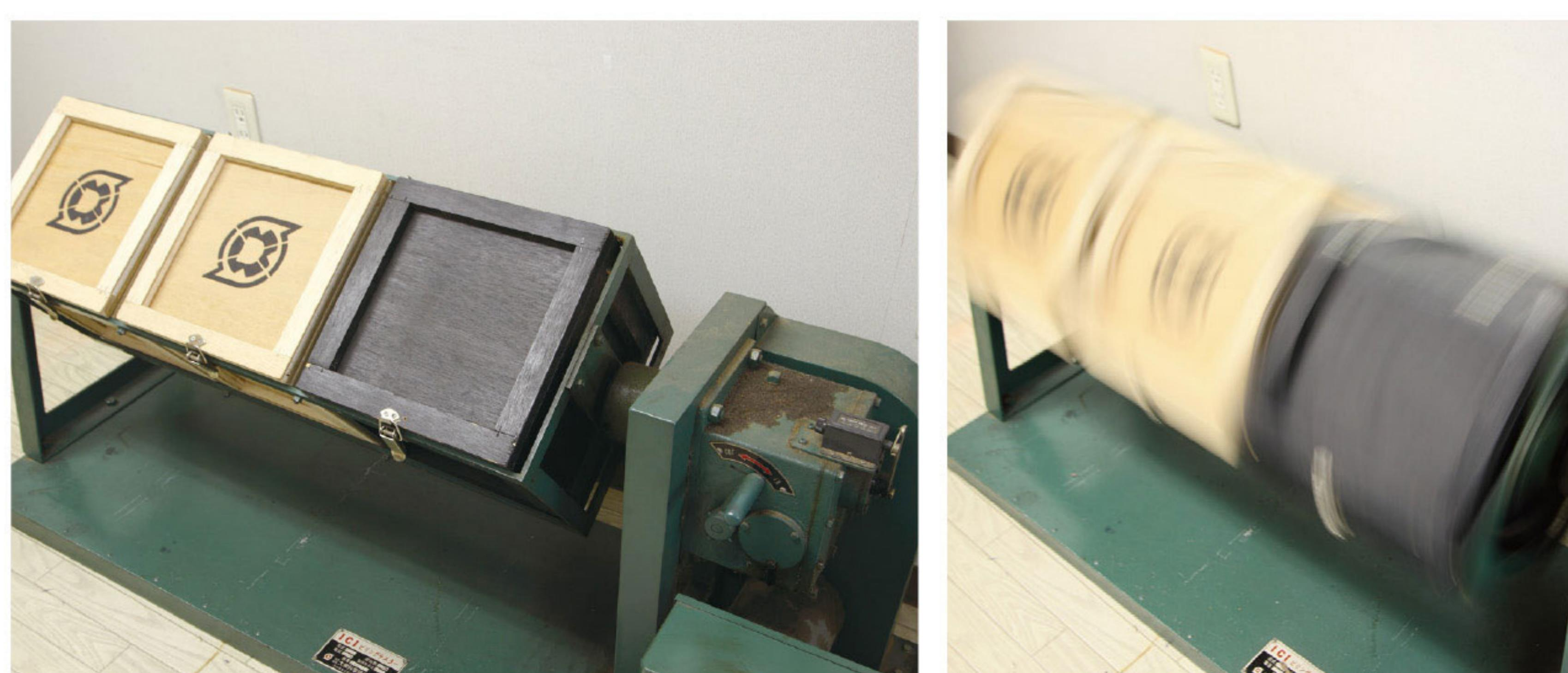
コルクで囲われた箱の中に入れられ、10時間回転させて、毛玉が発生する度合を測ります。糸の形状にもよりますが、糸の強度が必要以上に強すぎると、毛玉の発生につながります。糸の力よりも、組織のバランスで強度を保つように設計するのが、椅子張りの特徴です。
