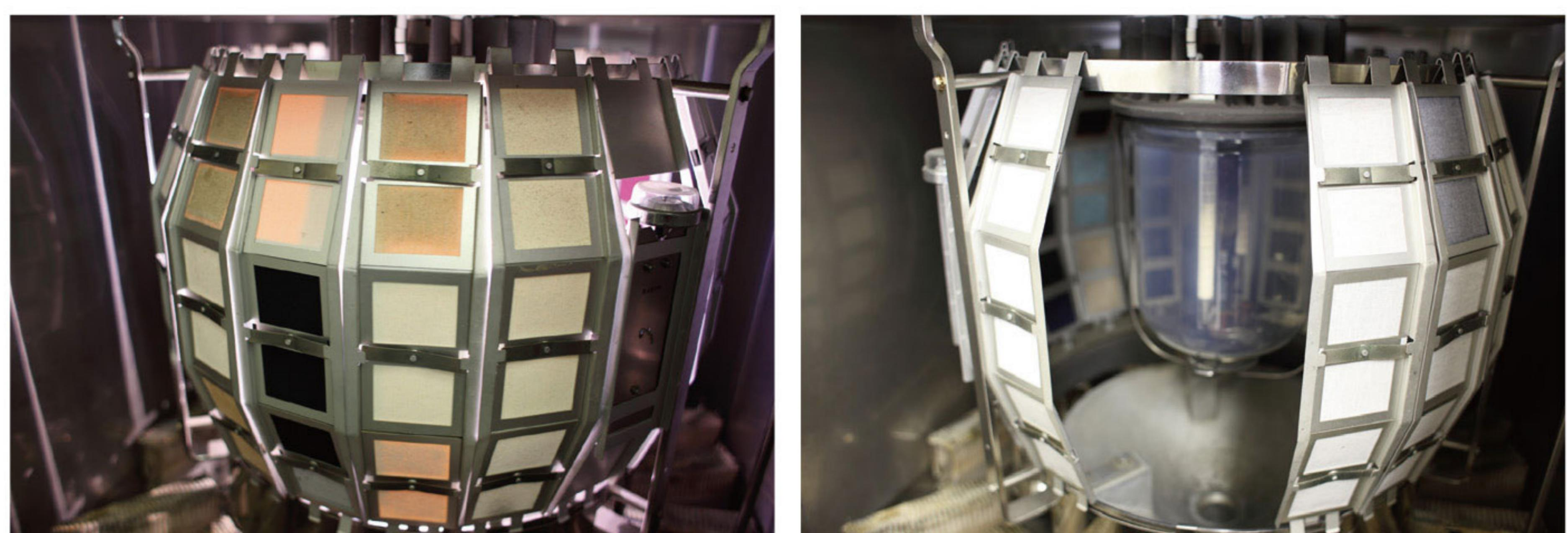
カーボン管に電流を流して紫外線を発光させ、光による色落ちの具合を計測します。フル稼働で試験しています。
