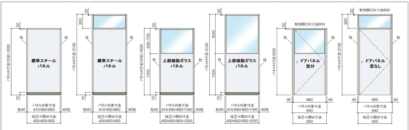
シンプルな部材構成の施工型スチール製ローパーティション「LPKシリーズ」。
