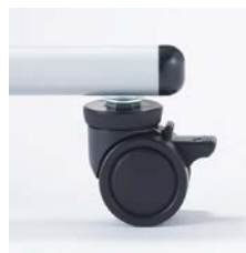
■アジャスト機能付キャスター キャスター上部のリングにより高さ調節 できます。制御力の高いリフトロック式 ストッパーです。
