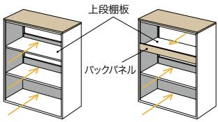
H1050タイプ、H700タイプの上段の棚板とバックパネルを前後反転させて取り付けることが可能です。収納物を取り出す方向が選択できて便利です。
