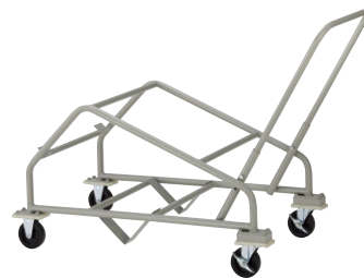
SK39 ¥62,100 ◆ 外寸法：W595×D1152×H811 本体：φ25.4mmスチール丸パイプ塗装仕上 車輪：単輪φ100ゴムキャスター 質量：12.0kg
