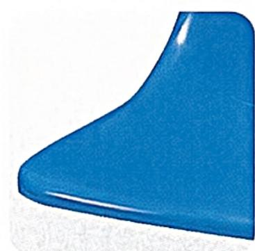
シート状のFRP圧縮成形材料を、金型を用いてホットプレス工法で製品化したものです。また、表面には、長期間の屋外使用に際しても外観を損なわないように、特殊樹脂コーティングを施しています。
