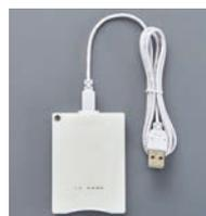
USB ICカードリーダーをパソコンに接続し、ICカードを本体にかざすだけで、ICカードのID(IDM・UID)をキーボードで入力したように取り込むことができます。
