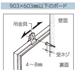
付属の吊金具をボード上部の枠に取り付けます。左右にスライドさせて壁面の受けネジへ吊金具の穴を確実に引っ掛けます。
