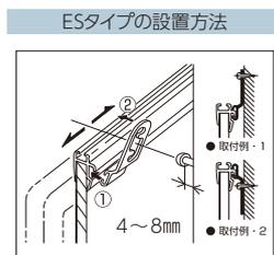
付属の吊具をボード枠の上部裏面に取り付けます。左右にスライドさせて壁面の受けネジへ吊具の穴を確実に引っ掛けます。
