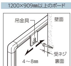
ボード表面上部に吊金具があらかじめ2個セットされています。左右にスライドさせて壁面の受けネジへ吊金具の穴を確実に引っ掛けます。
