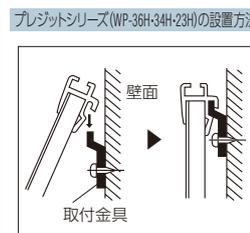
1.壁面に付属の取付金具を取り付けます。
