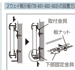
1.壁面に金具を取り付け、ボードを吊り下げます。
