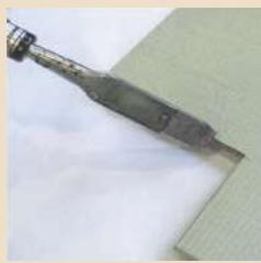
②裁断面の仕上げと畳表のほつれ防止のため、はんだこて、アイロンなどで畳表の端面を溶かします。(温度は230°C程度が適温です。)
