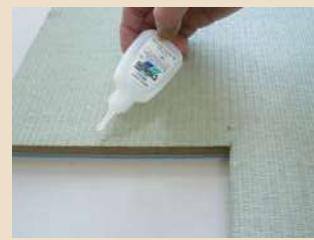
③畳表のほつれ止めのため畳表の裁断面に瞬間接着剤を施します。
