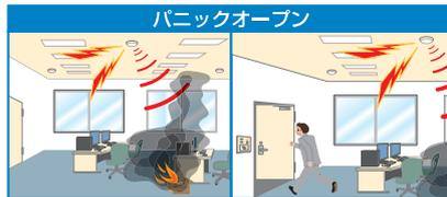
火災発生時にお客さまの避難をスムーズにするため、電気錠を自動的に強制解錠します。火災時の盗難を防ぐため、火災発生時でも電気錠が自動解錠しないよう設定することも可能です。
