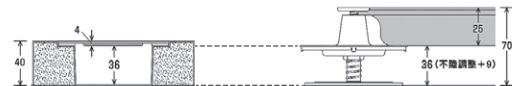
●ネットワークフロアは床高が低いのに、他の床高70mm程度の二重床タイプのOAフロアと同じ配線有効高があります。(ネットワークフロア40の例) そのため、LAN用コネクターなどの収納も自由自在です。
