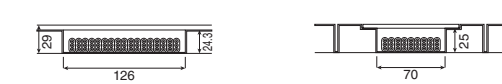
●フィードインマット29N (VVF2mm・3芯×17本) ●ベースマット29 (VVF2mm・3芯×9本)
