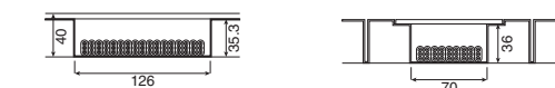
●フィードインマット40N (VVF2mm・3芯×17本) ●ベースマット40 (VVF2mm・3芯×9本)
