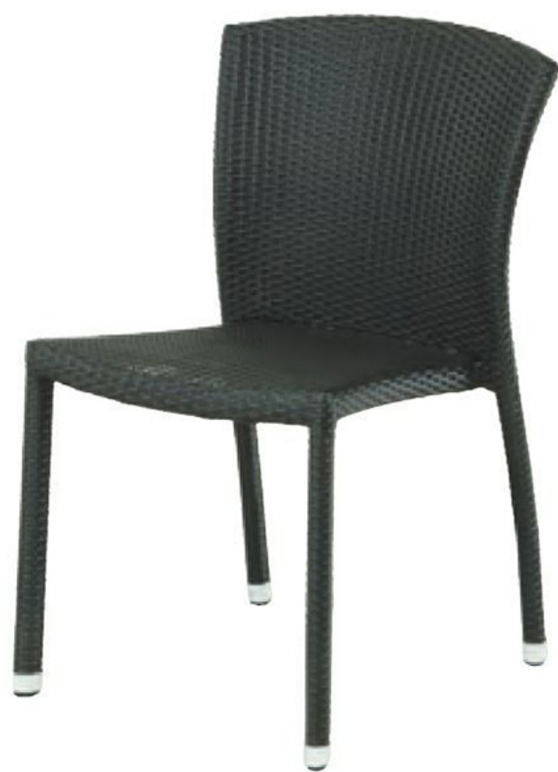
02557 MAC-4SC ● ¥31,000 寸法 W 515 D 580 SH 450 H 815 wt. 3.7kg 材質 フレーム：アルミ，背・座：P.E.(ブラック) 梱包 1～2脚：1梱包 15.5才 備考 スタッキング式
