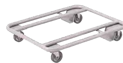
12-395-7 レセプションチェア用台車F ¥70,000 W545・D700・H126 フレーム：φ25.4丸パイプ・焼付塗装(グレー) 積載能力：50kg 車輪：φ75前輪自在式
