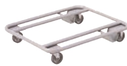
11-530-13 レセプションチェア用台車F ¥ 40,600 (W545・D700・H126) フレーム:φ25.4丸パイプ・焼付塗装(グレー) 積載能力:50kg 車輪:φ75前輪自在式
