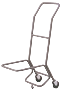
11-530-12 レセプションチェア用台車E ¥ 36,000 (W373・D747・H1,120) フレーム:φ25.4丸パイプ・焼付塗装(グレー) 積載能力:50kg 車輪:ハンマーキャスター(2-φ100)(1-φ32)
